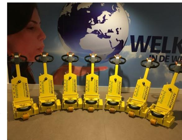
Le poussoir pneumatique accroché comprends un moteur pneumatique, un actionneur pneumatique pour le crochet et un timon avec les contrôles de vitesse et d'accrochage. De tracteurs à contrôle rémotisé sont aussi disponibles.
